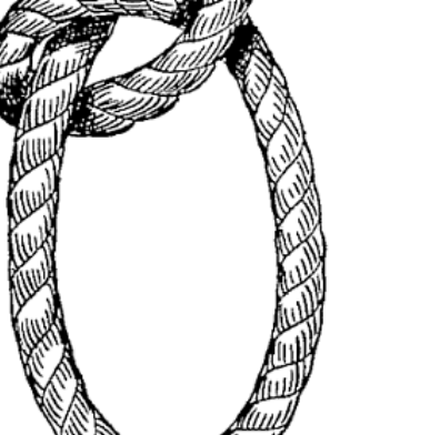
FIG. 51 A.—Roband hitch (front).
